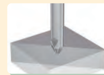
位置決め/Spot Drilling
